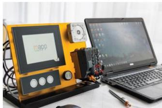
ETA 시스템(ETA system)은 훈련, 교육 및 실험실에서 사용하기 위해 실제와 같은 구조를 제공합니다. 두가지 이상의 다른 기구 구조가 선택될 수 있습니다. ETA light system 은 높은 자유도, 공간 절약 및 연구소 작업에 적합합니다. ETA standard system 은 튼튼한 기구 구조와 사전에 와이어링된 센서와 액추에이터를 포함합니다.
